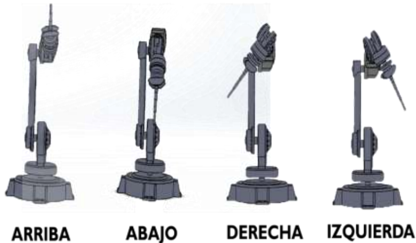
Fig. 5. Movimientos del brazo laparoscopio controlado mediante comandos de voz.
