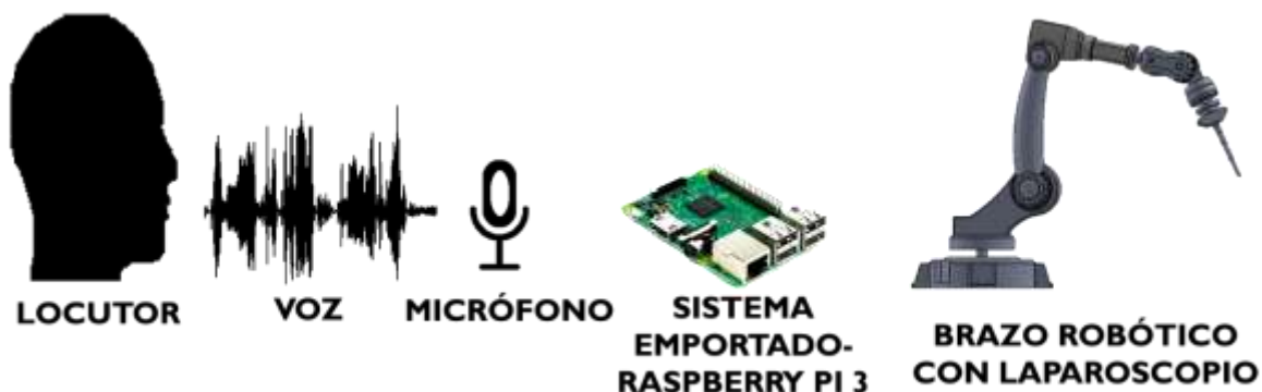
Fig. 4. Funcionamiento del sistema de control por voz y brazo laparoscópico.
