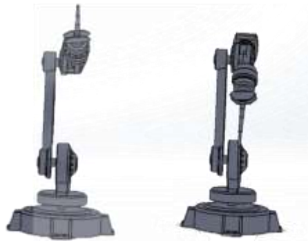
Fig. 1. Brazo realizado en SolidWorks CAD.
