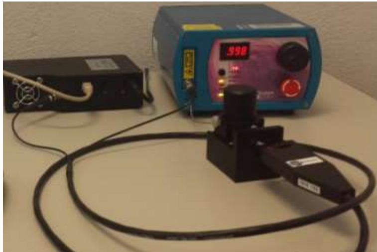
Figura 1. Arreglo experimental de la medición de los aceites de oliva y de cacahuete.
