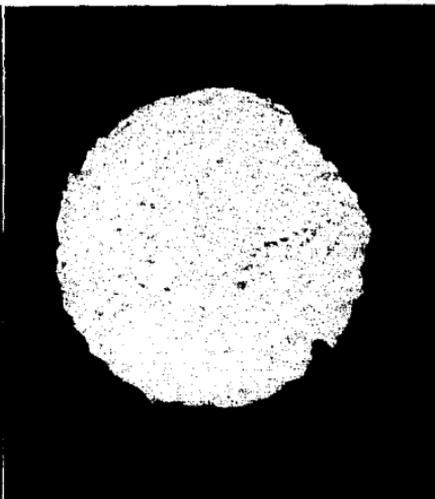
Figura I.11 Fibra óptica terminada con lija del 280, grano de 100  $\mu\text{m}$  (200X)
