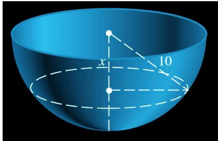
**Solución** Como peso del agua se toma 10 000 newtons por metro cúbico (10 kN por  $m^3$ ). No es difícil ver que la sección transversal a  $x$  metros de la parte más alta del depósito es un disco de radio  $\sqrt{100 - x^2}$ . Luego su área es
