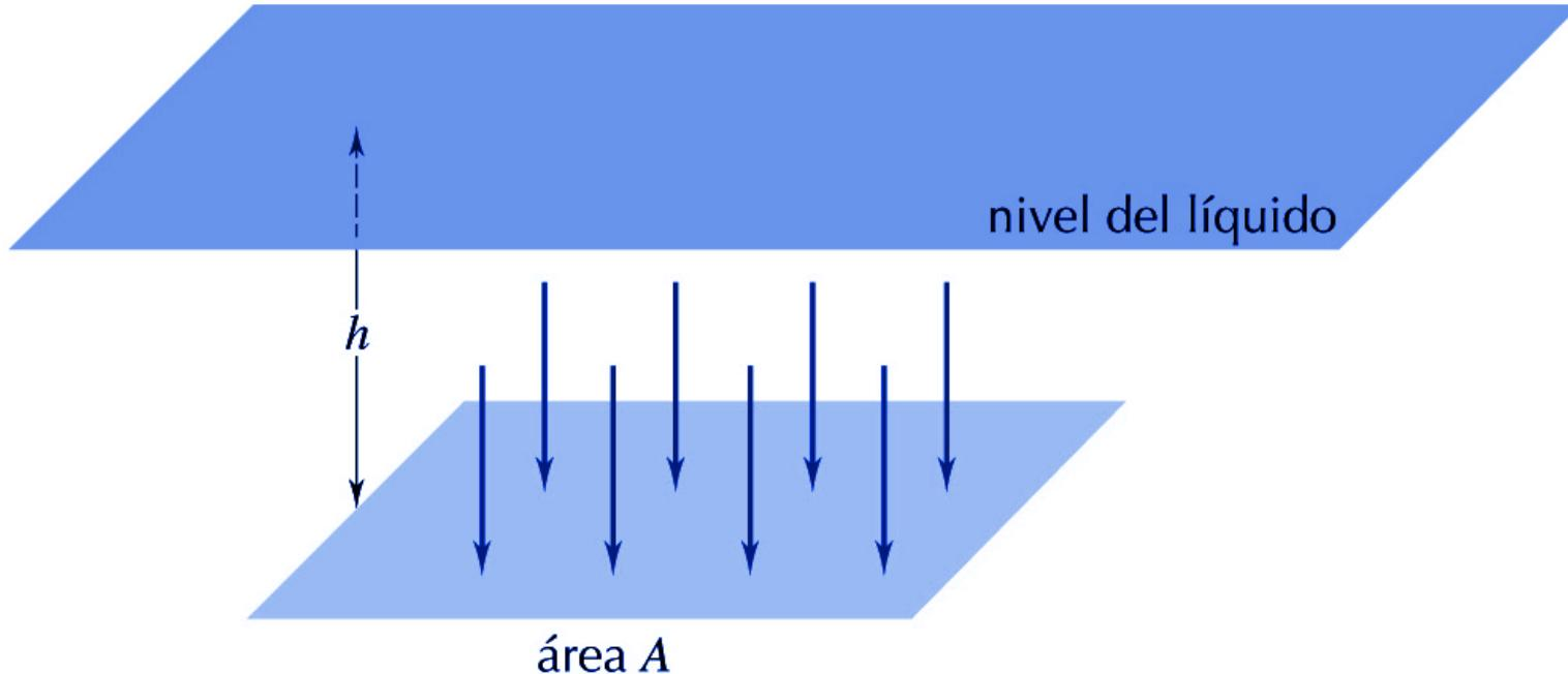
**Observación sobre las unidades** Si el área se mide en metros cuadrados, la profundidad en metros y el peso específico en newtons por metro cúbico, la fuerza del fluido se mide en newtons.
