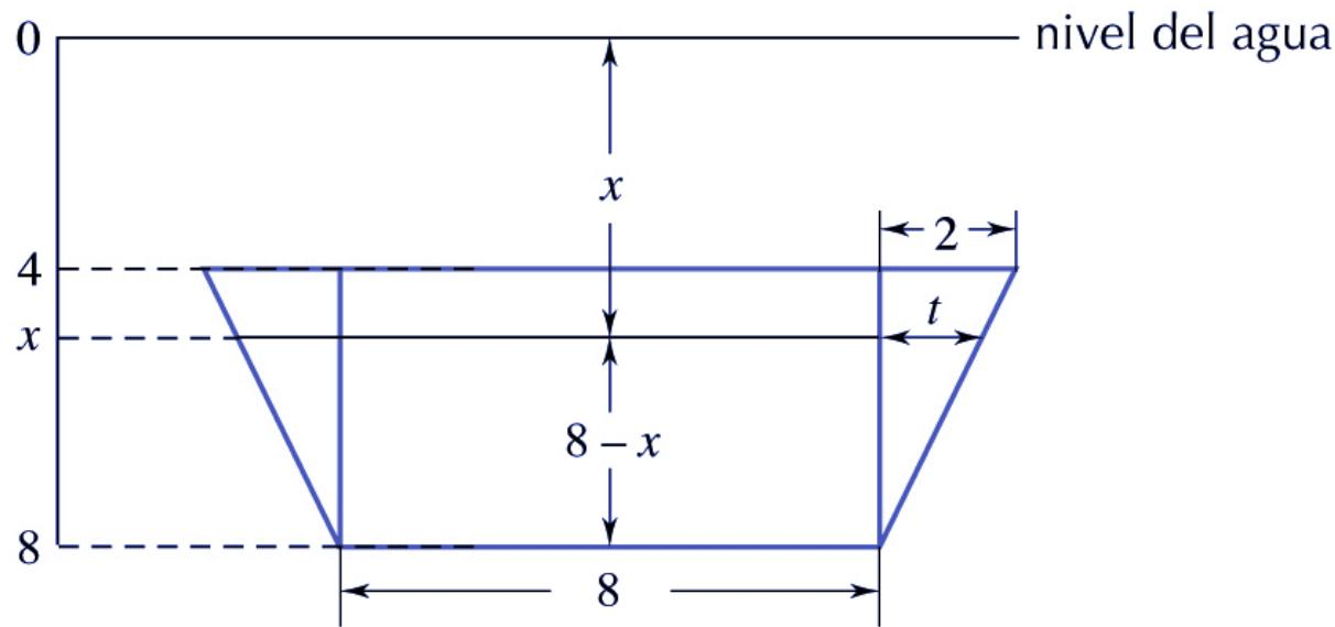
**Solución** Primero definiremos el ancho de la placa a la profundidad de  $x$  metros. Por triángulos semejantes (ver figura 6.6.6)
