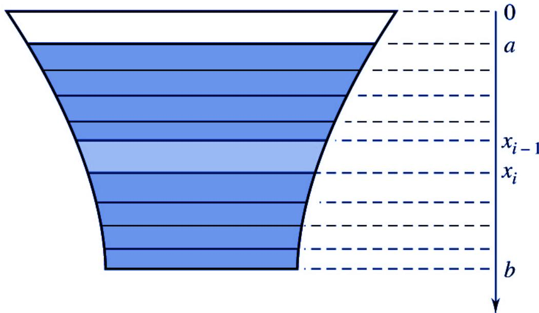
Como en el dibujo, supondremos que el líquido está situado entre las profundidades  $a$  y  $b$  y designaremos por  $w(x)$  la anchura de la pared a la profundidad  $x$ . Una partición  $P = \{x_0, x_1, \dots, x_n\}$  de  $[a, b]$  de norma pequeña subdivide la pared en  $n$  pequeñas franjas horizontales. (Figura 6.6.3.)
