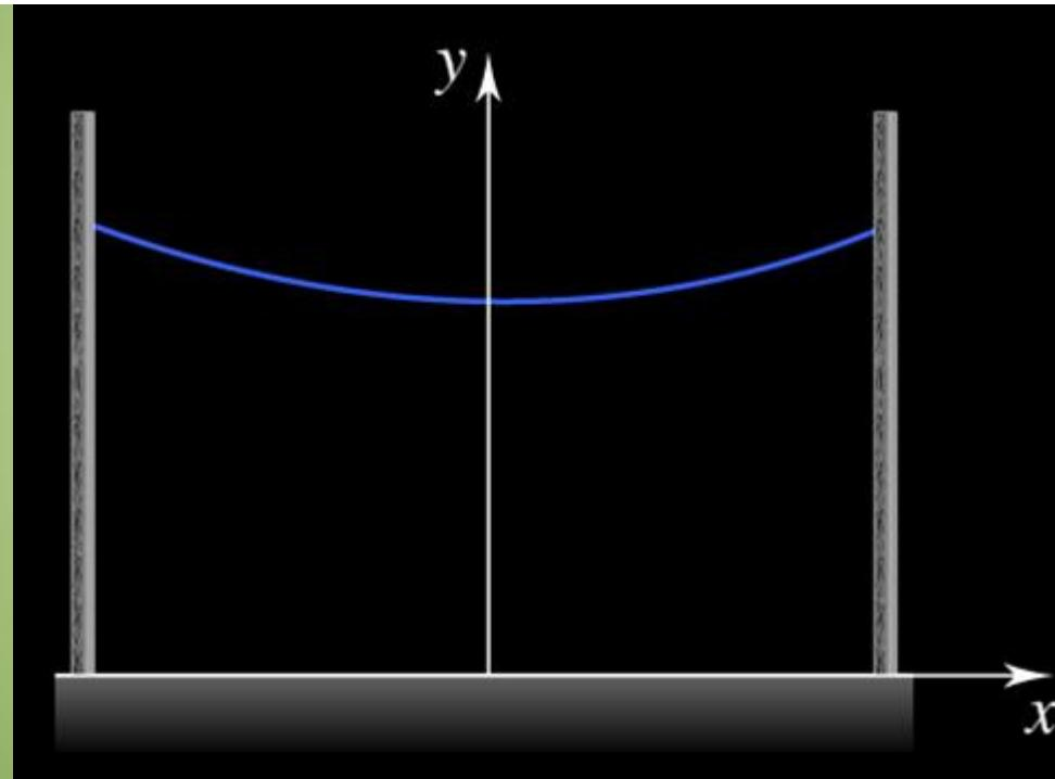
Supongamos que tenemos un cable flexible de densidad uniforme suspendido entre dos puntos de igual altura. Si introducimos un sistema de coordenadas  $x$ - $y$  de manera que el punto más bajo del cable se encuentre sobre el eje  $y$  (figura 7.8.5), se puede demostrar que la forma de la curva  $y = f(x)$  debe verificar la ecuación diferencial
