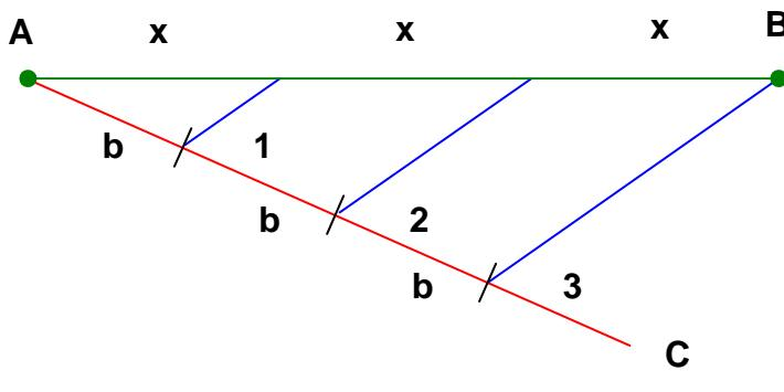
A partir del extremo A se traza la semirecta AC con cualquier inclinación. Sobre ella partiendo de A, se marcan sucesivamente 3 marcas de longitud  $b$  (divisor). El extremo del 3er segmento  $b$  se une con B y se trazan paralelas al segmento  $B3$  por los puntos 1 y 2. Entonces,
