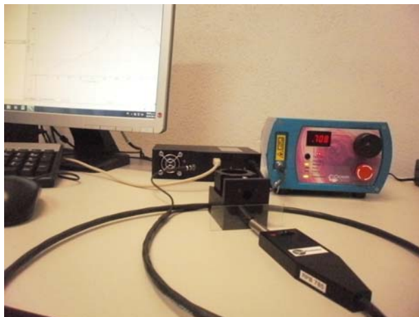
Figura 1 Arreglo experimental de las mediciones con Espectroscopia Raman.
