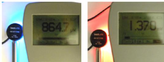
Figura 2.- Medición de la potencia óptica de las fuentes de luz LED.
