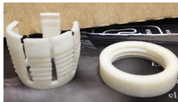
Figura 5. Puntos de ruptura del prototipo.
