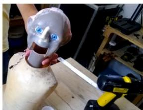
Fig. 2. Prototipado en fibra de vidrio del robot humanoide “Franky”.
