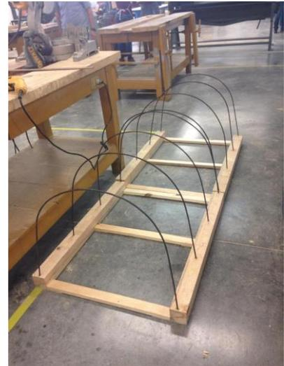
En estas imágenes se muestran los materiales y parte del proceso de fabricación del túnel didáctico, en el laboratorio de la Facultad de Arquitectura UANL.
