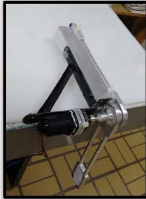
Figura 12. Motor acoplado a una órtesis asistencial de miembro inferior.
