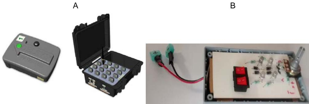
Figura 1. A) Sistema Trigno™ Wireless System B) Estimulador conformado por una batería de 9 V y un puente de transistores.
