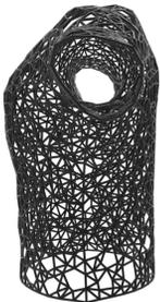
La implementación de la tecnología por el programa de modelado permite asignarle las medidas y requerimientos de cualquier tipo de complejidad de los usuarios, lo que da pie a una parametrización total del dispositivo médico el cual no requiere de un plano técnico ya que esta cambia estructural y dimensionalmente para cada paciente.
