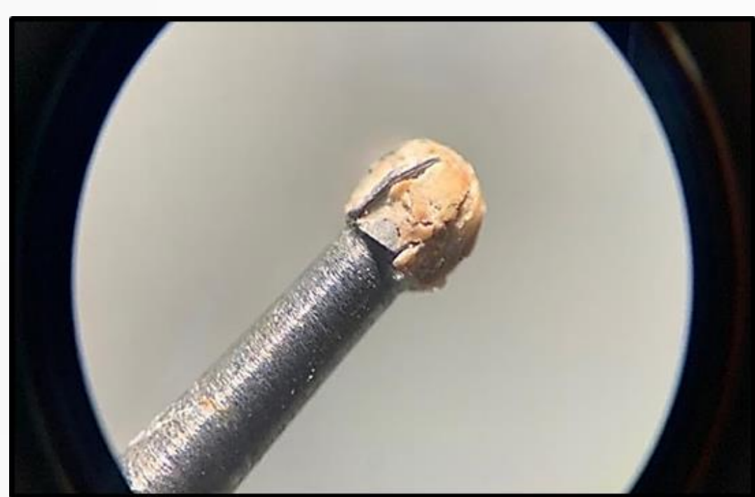
Fig. 1. Fresa de carburo después de su uso, vista al microscopio estereoscópico
