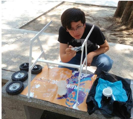
Figura 4. Elaboración de silla de ruedas canina para patas delantera
