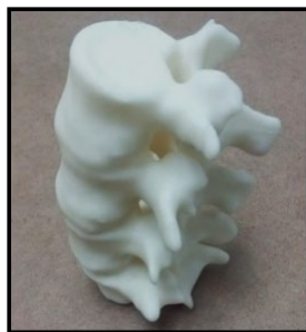
Imagen 1 impresión de vertebras después de retirar soportes
