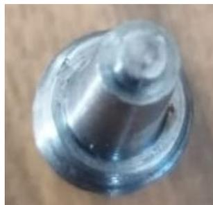
Figura 7. Indentador de 5 mm diámetro
