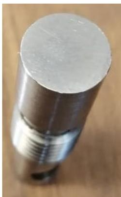
Figura 6 Indentador de 9mm de diámetro
