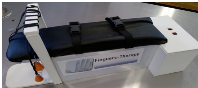
Figura 3.4 Prototipo Final Del Rehabilitador
