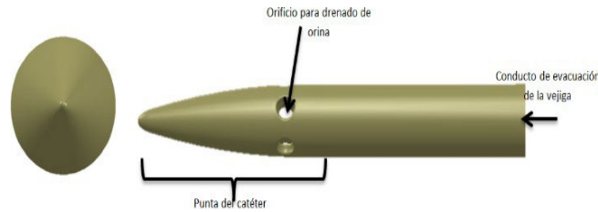
Figura 8. Vista lateral con dimensiones de la Punta del Catéter Optimizado
