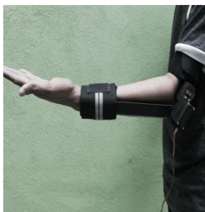
Figura 5. Exoesqueleto principal que replica movimientos basándose en una red de sensores
