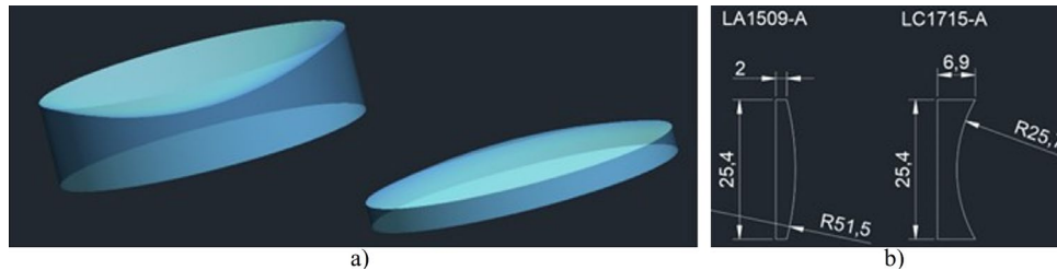
Figura 1. a) Render de las lentes LA1509-A y LC1715-A, b) Parámetros de diseño de cada lente
