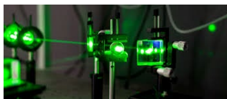
Figura 3. Arreglo de lentes convergentes para colimar un haz de luz producido por un láser sobre un cristal
