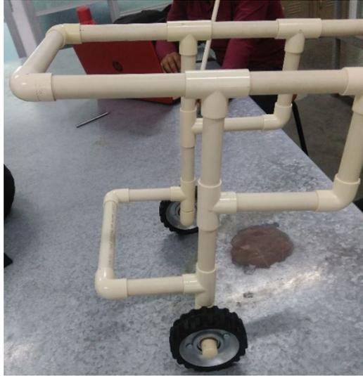
Figura 2. Modelo de la silla de ruedas ya hecho de PVC
