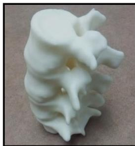
Imagen 1 impresión de vertebras después de retirar soportes
