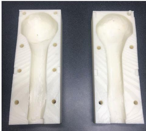
Figura 2. Molde del humero obtenido impreso en 3D con material ABS
