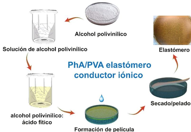
Figura 1. Ilustración esquemática de la preparación del elastómero de alcohol polivinílico (PVA): ácido fitico (PhA)
