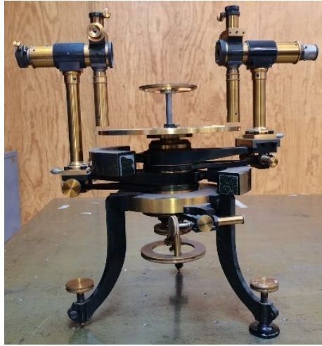
Figura 2. Espectro goniómetro (R.Fuess, Berlín, 1879)
